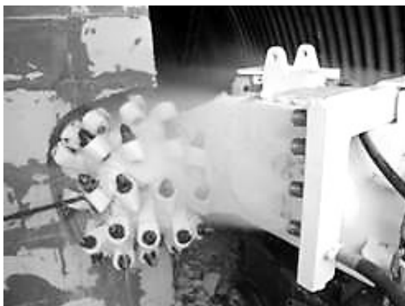
Rys. 6.3 Inżektorowy system zraszania w kombajnie chodnikowym
