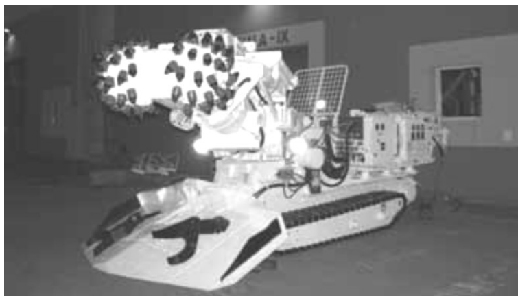
Rys. 6.2 Kombajn chodnikowy AM-50z-w z inżektorowym systemem zraszania
