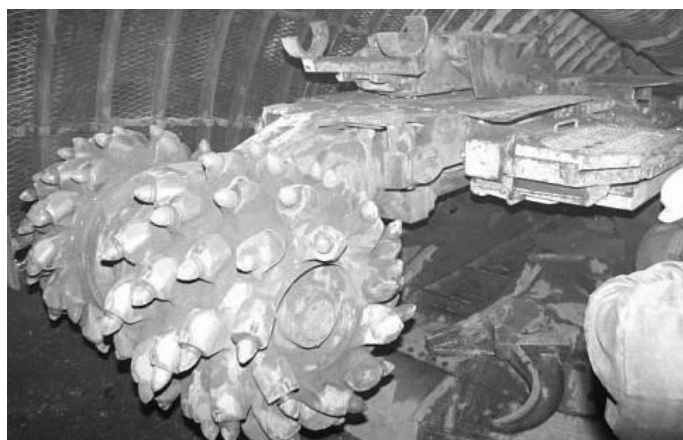
Obr. 5.2 Řezný orgán razícího kombajnu MR-340
