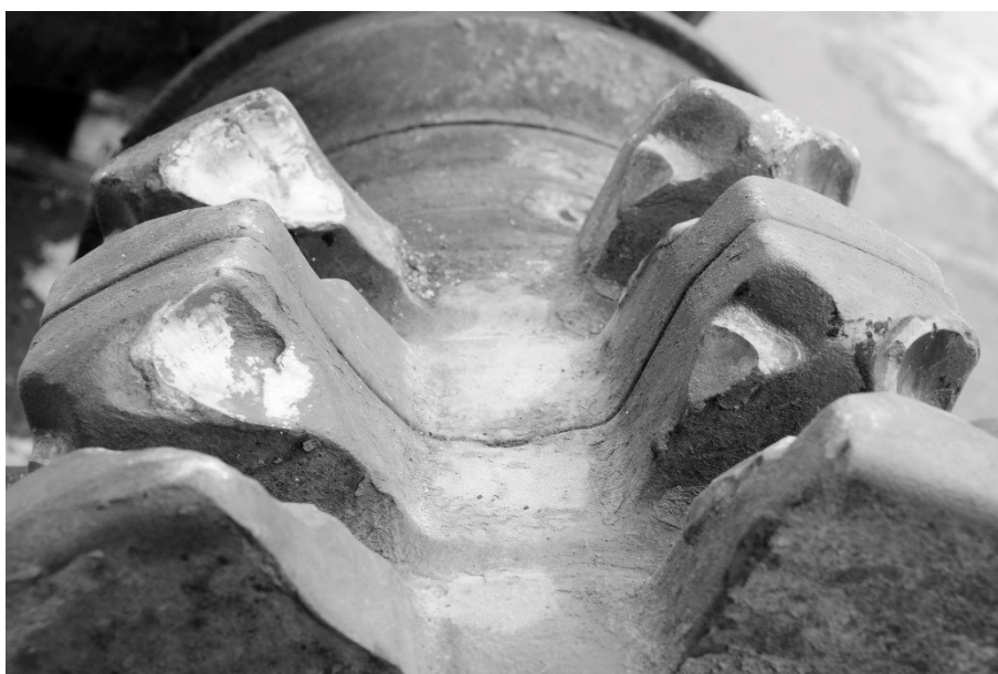
Rys. 2.1 Bęben łańcuchowy wycofany z eksploatacji ze względu na duży stopień zużycia
