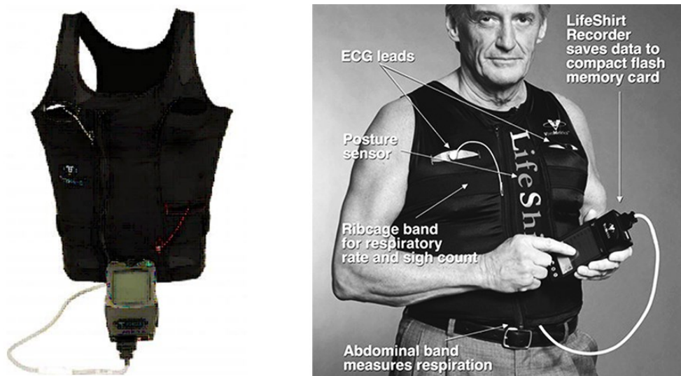
Rys. 1.2. Life shirt (życiodajna koszula) firmy VivoMetrics, mierzy 40 parametrów, m.in. zużycie tlenu, czy poziom płynu osierdziowego.
