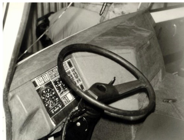
Rys. 11.2 Model wnętrza kabiny 1:1 - plastelina
