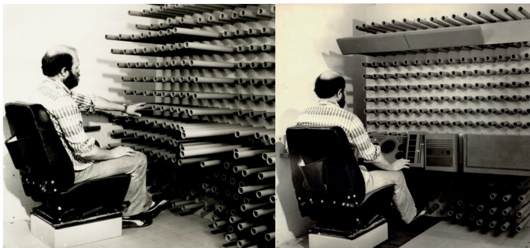
Rys. 11.1 Przyrząd badawczy symulujący przestrzeń prac kierowcy.
